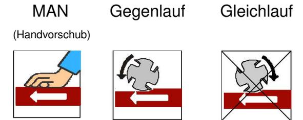
Mit „MAN“ gekennzeichnete Werkzeuge dürfen auf Maschinen mit mechanischem Vorschub verwendet werden. Fräsen im Gleichlauf ist wegen der Rückschlaggefahr verboten.
